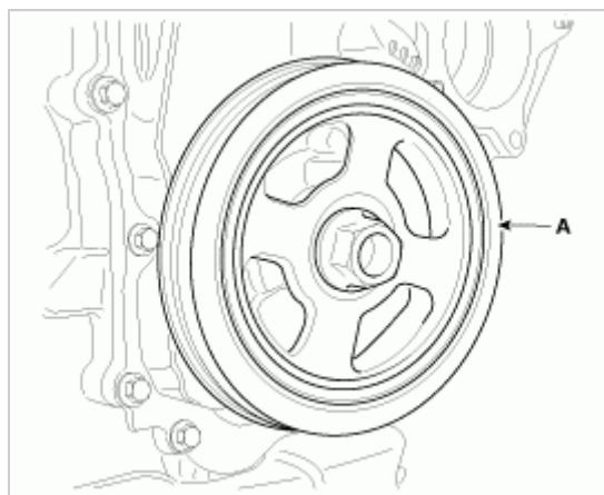
拆卸起动机后，使用专用工具(09231-3N100, 09231- 2B100)固定齿圈。然后拧下曲轴减振皮带轮螺栓。
